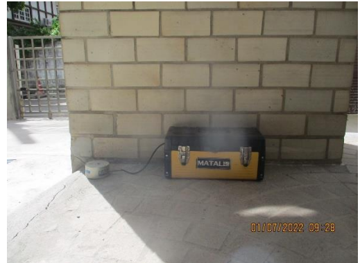
รูปที่ 2.24 การติดตั้งเครื่องวัดความสั่นสะเทือน
